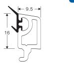
SLIDING SINGLE GALZED BEAD Code: SB-2003 WEIGHT(KG/M): 0.270 LENGTH: 5.9 M
