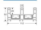
66 SLIDING WINDOW SASH WEIGHT(KG/M): 1.062 LENGTH: 5.9 M
